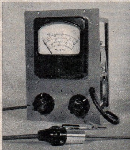
Abb. 4. Röhrenvoltmeter mit Tastkopf gemäß Schaltung Abb. 5
